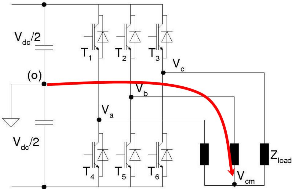
В инверторе типа АИН напряжение Common Mode Voltage в любой момент времени имеет значение:
